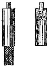
mités par un tampon de composition vive, muni d'une petite mèche. Il prend feu très facilement par tous les temps, et allume l'extrémité de la mèche introduite dans le vide de la douille et fixée en contact avec le tampon.
