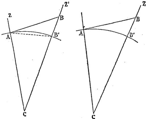
la hauteur du point B au-dessus du point A, soit CA et CB les verticales de A et B, soit AB' une ligne de niveau passant en A; ce qu'il faut estimer, c'est la longueur BB'. A cet effet, on mesure les distances zénithales ZAB = ζ, Z'BA = ζ' en ayant soin de les corriger de la réfraction, et la distance AB' que nous désignerons par K. Nous aurons alors :
