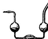
Fig. 12. — Tube condensateur pour le dosage de l'azote sous forme d'ammoniaque.
