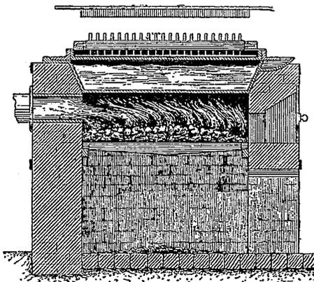
Fig. 3. — Coupe du plateau à tremper les allumettes.
