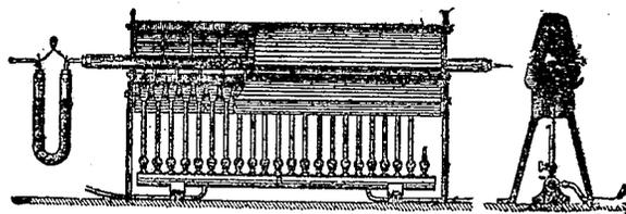
Fig. 9. — Tube à combustion de Cloëz.
