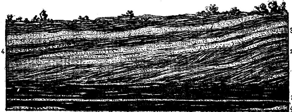
Fig. 6. — Coupe verticale montrant, dans la tranchée Saint-Edmond, la disposition habituelle en couches inclinées des grès, schistes et conglomérats au toit de la Grande Couche de Commentry (d'après une photographie). — 1, Grande Couche avec veines de grès intercalées; 2, schistes charbonneux et filets de grès; 3, grès charbonneux passant latéralement aux schistes; 4, conglomérats à éléments granitiques et gneissiques.
