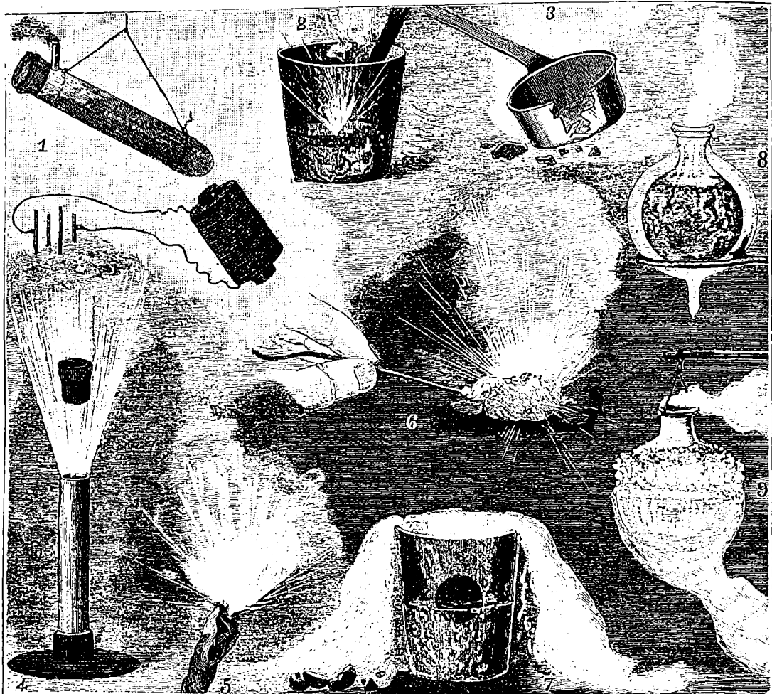
L'AIR LIQUIDE. — 1. Magnétisme de l'oxygène. — 2. Acier brûlant dans l'oxygène liquide. — 3. Casserole de fer brisée. — 4. Explosion d'air liquide en vase clos. — 5. Journal plongé dans l'air liquide et brûlant. — 6. Éponge imprégnée d'air liquide. — 7. Balle de caoutchouc congelée. — 8. Ballon à double enveloppe. — 9. Air liquide en ébullition.
