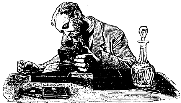
LE MOUVEMENT PHOTOGRAPHIQUE. — Projection dans le bain fixateur de la plaque développée dans l'hémérascope.
