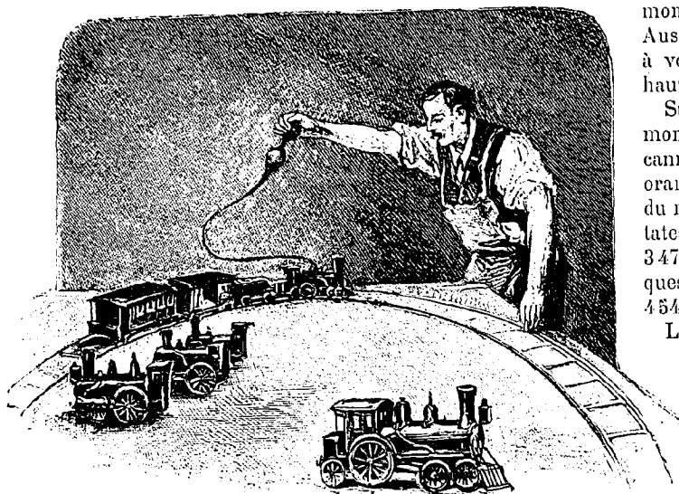
LA FABRICATION DES JOUETS D'ENFANT. — L'essai des locomotives, par l'air comprimé.
