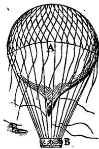
Le ballon A est une enveloppe de taffetas enduite d'un vernis élastique et remplie de gaz hydrogène. La partie supérieure du ballon est couverte d'un filet auquel se rattachent les fils qui soutiennent la nacelle B. Le ballon n'est pas exactement fermé, parce que la force expansive du gaz le briserait quand il arriverait dans les couches supérieures de l'atmosphère, où la pression de l'air est beaucoup moins forte. Pour prévenir cet accident, on le laisse
