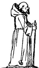
L'une des extrémités d'une corde à boyau étant fixée au corps de l'instrument, et l'autre à une pièce mobile (dans ce cas le capuchon), on comprend que la pièce mobile se rapproche par l'humidité (et alors le capucin a la tête couverte) ou s'éloigne par la sécheresse (et alors le capuchon tombe sur le dos). On peut donc ainsi connaître approximativement l'humidité du temps.
