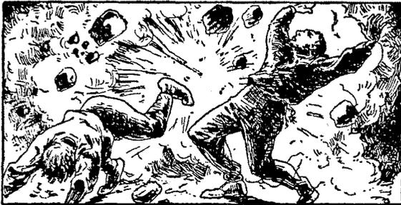
23. Dans les mines de houille, il y a à redouter les explosions de *grisou*. Le grisou est un gaz analogue au gaz de l'éclairage (p. 77) et qui se dégage de la houille.
