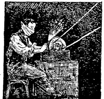
32-33. Aiguille et ouvrier aigüisant un paquet d'aiguilles.
