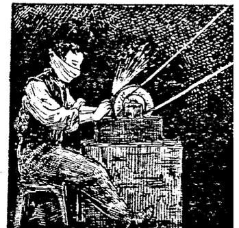
32-33. Aiguille et ouvrier aiguissant paquet d'aiguilles.
