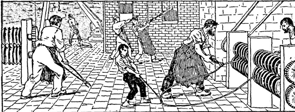
24. On fait passer une barre de fer rougie au feu entre les cannelures\* de plus en plus troites d'un *laminoir*\*, formé de deux cylindres tournant en sens inverse l'un de l'autre et mus par une forte machine. La barre de fer devient, dès lors, de plus en plus longue et de plus en plus mince.
