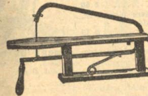
**MACHINE** à découper le bois, se fixant à une table, livrée avec presse de fixation et poignée de tirage.
