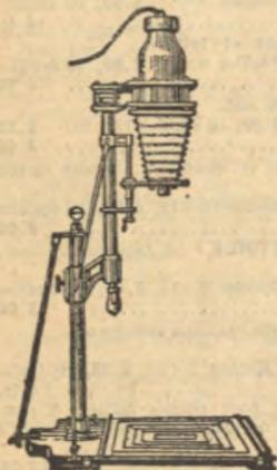
**AGRANDISSEUR** vertical « Noxa » nouveau modèle entièrement métallique permettant d'obtenir une grande épreuve sur papier avec un petit cliché aussi facilement que des épreuves au châssis-presse. Monté avec anastigmat spécial F.6.8. N° 7, clichés 4½x6, Vest-Pocket agrandis, jusqu'au 18x24. Prix ..... 680 fr. N° 8, clichés 6½x9 et au-dessous, agrandis, jusqu'au 30x40. Prix ..... 789 fr. N° 9, clichés 9x12 et au-dessous, agrandis, jusqu'au 40x50. Prix ..... 1.100 fr.
