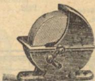
**MEULE grès, auge et bâti fer soudé à l'autogène, à pédale et à main.**
