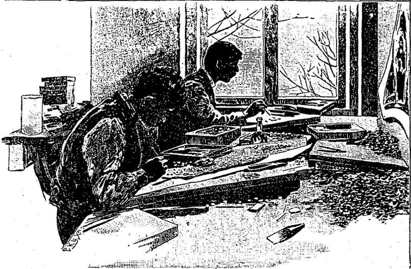
Fig. 132. — Assemblage des « smaltes » pour l'établissement d'une mosaïque.
