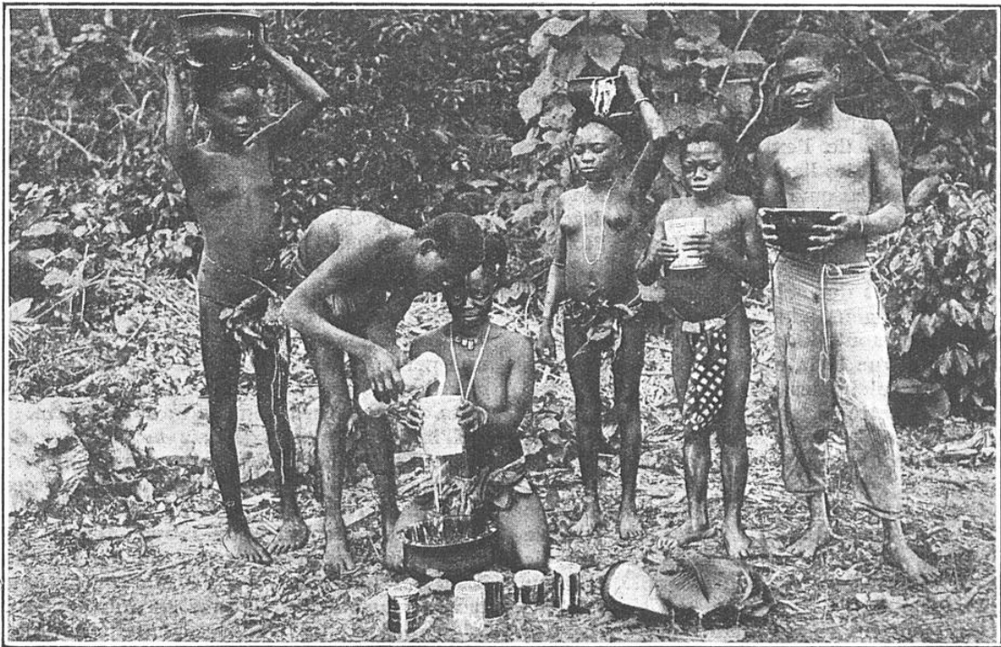
FILTRAGE DU LATEX MÉLANGÉ AVEC UN TIERS D'EAU
