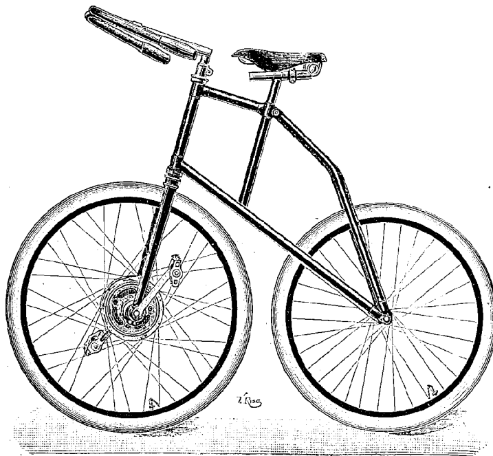
LES INVENTIONS NOUVELLES. La cyclette sans chaîne (système Deschamps).
