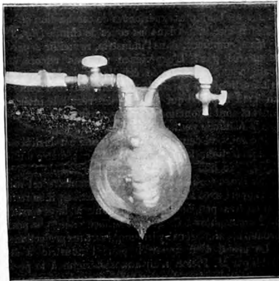
L'AIR LIQUIDE. — Fig. 5. Appareil pour la liquéfaction de l'air à basse pression.
