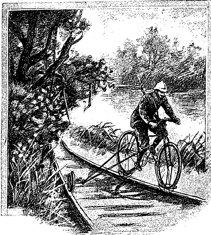
LA BICYCLETTE SUR RAILS. — Dispositif de la roue annexe.
