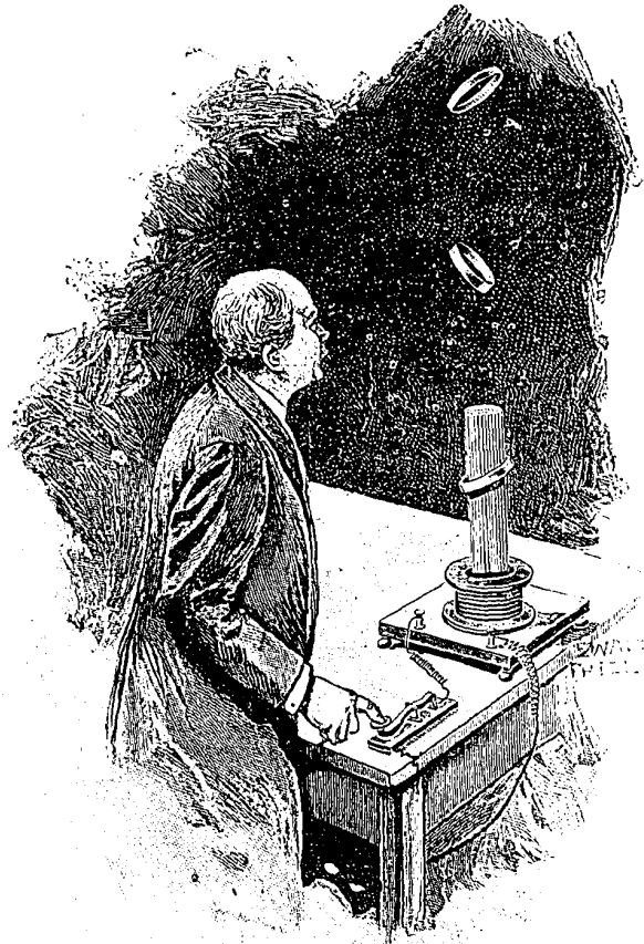
EXPÉRIENCES RELATIVES AUX COURANTS ALTERNATIFS DE HAUTE TENSION. — Action répulsive des courants alternatifs sur les conducteurs qui les absorbent.
