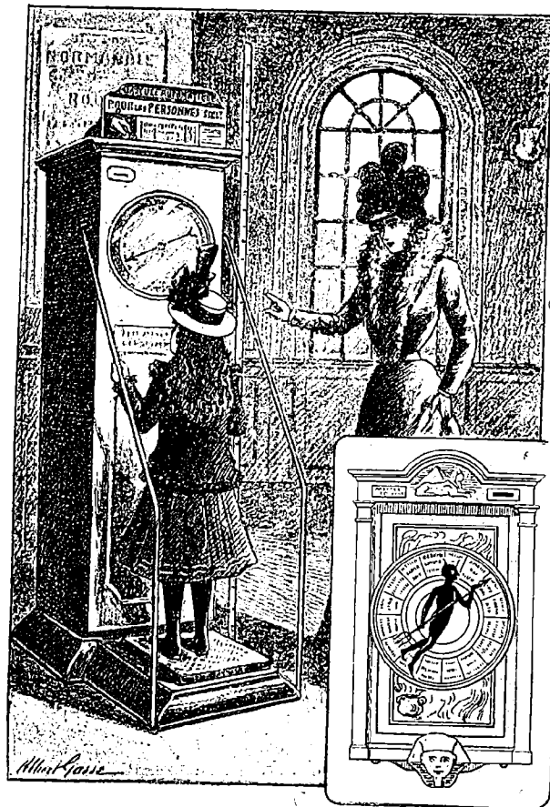
DISTRIBUTEURS AUTOMATIQUES A DÉCLENCHEMENT SIMPLE. 1. Bascule automatique. — 2. Horoscope.
