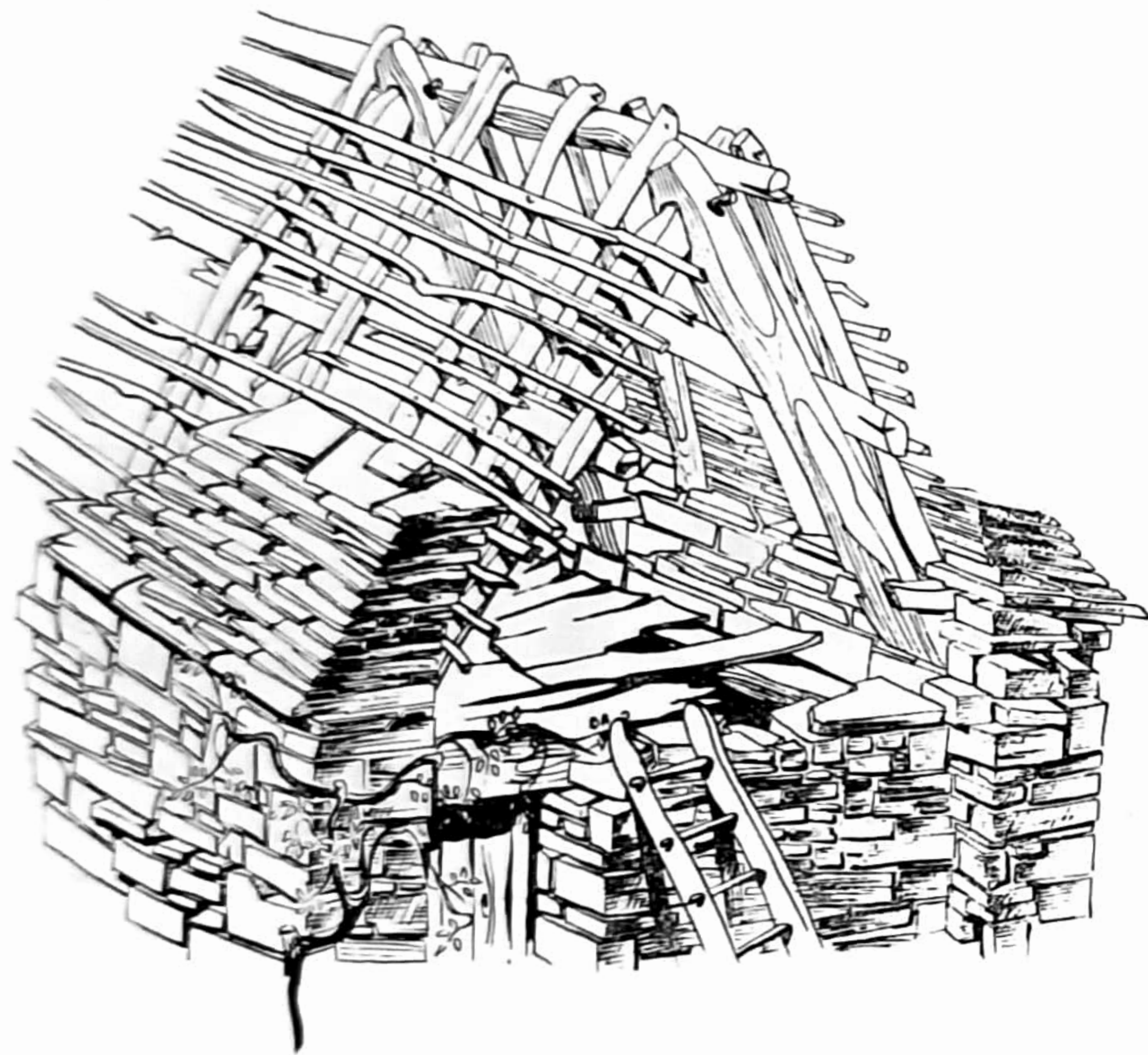
CHARPENTE RUDIMENTAIRE EN « TAS DE CHARGE » POUR UN TOIT DE PIERRE A LIMOGNE
