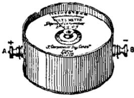
Fig. 5. — Ampèremètre industriel (Carpentier).
