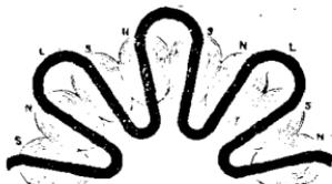
Fig. 59. montrant l'armature induite passant devant les électros inducteurs.
