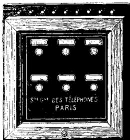
Fig. 1. — Vue extérieure d'un Tableau à 6 guichets.
