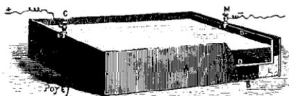
Fig. 15. — Pile de Lalande et Chaperon (élément à auge).
