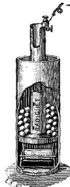
Fig. 38. — Pile Radiguet (vase poreux intérieur).
