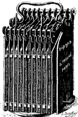
Fig. 49. — Pile pour galvanocaustique de M. Trouvé (disposition des éléments).
