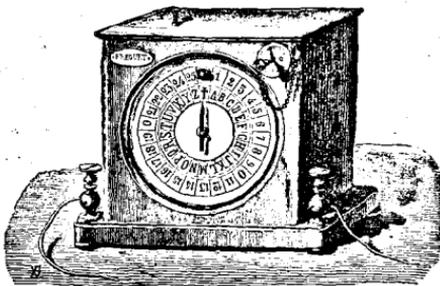
Fig. 11. — Vue extérieure du Récepteur à cadran.
