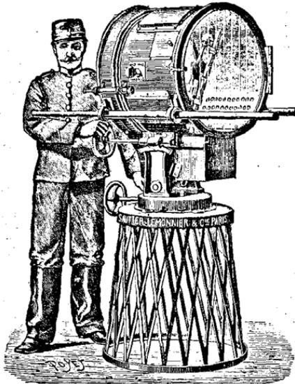
Fig. 1. — Projecteur Mangin placé sur un socle en treillis.
