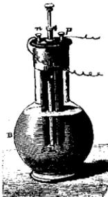
Fig. 18. — Pile Grenet à bouteille.
