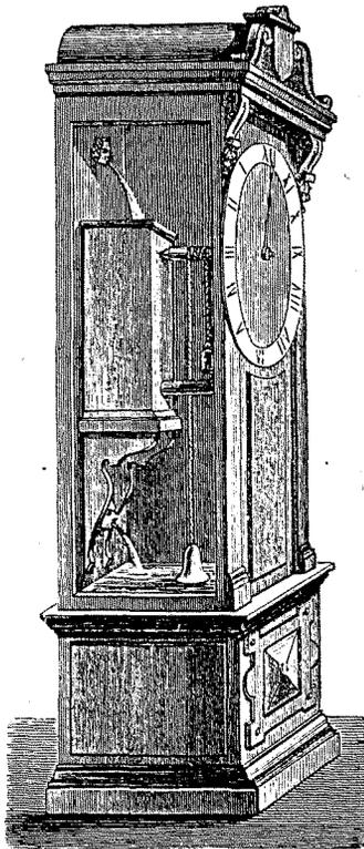
Fig. 34. Clepsydre à roue dentée et à cadran.
