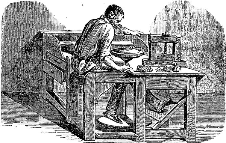
Fig. 81. Façonnage d'une assiette sur le tour avec le gabarit.
