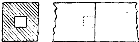
Fig. 10. Assemblage des pièces debout par tenon et mortaise.
