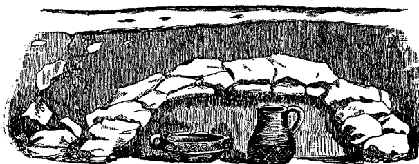
Fig. 39. — Tumulus. La pierre, sans assises régulières, forme ossature sous la terre qui, par son poids, maintient les matériaux juxtaposés (élément rudimentaire de la voûte).
