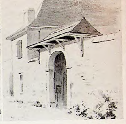
3 VARIANTES DU PORCHE BÉARNAIS . Le premier est soutenu simplement par sa charpente à 1 console ou potence, reposant directement sur le mur de clôture ; le 2 e couronnant le pan de mur plus élevé, encadrant le Porche ; le 3 e également à encadrement saillant au-dessus du mur, soutenu par deux consoles d'extrémité et par deux traverses intermédiaires.
