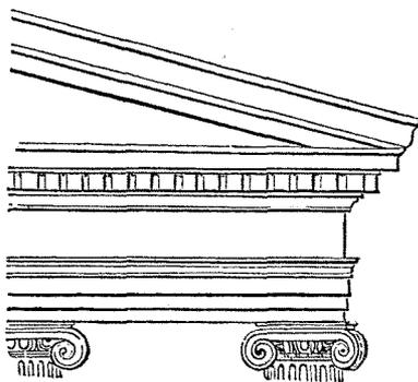
l'architrave de la corniche (Vitruv. III, 5, 10); il couvre extérieurement l'espace occupé dans la charpente du toit par les entrails (*tigna*), dont l'extrémité est représentée dans l'entablement dorique par les triglyphes de la frise (voy. la gravure à
