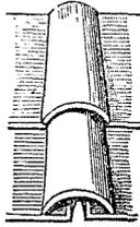
2. *Imbrix supinus*. Rigole formée par une série de tuiles faitières ajustées l'une à l'autre et placées sur leur dos (Columell. IX, 13, 6; cf. II, 2, 9), comme dans le spécimen ci-joint, qui montre une con-
