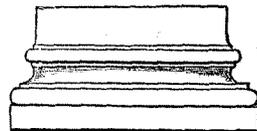
employé ordinairement en grec pour désigner une brique ou une tuile, d'où, par suite, les architectes romains vinrent à l'employer pour désigner la partie inférieure de la base d'une colonne, ce que nous appelons la *plinthe*, plaque carrée, ressemblant assez à une tuile épaisse, qui est placée sous le plus bas *torus*, et qui dut son origine à la nécessité où, dans les premiers âges de l'architecture, on se trouva de placer une grande surface plate
