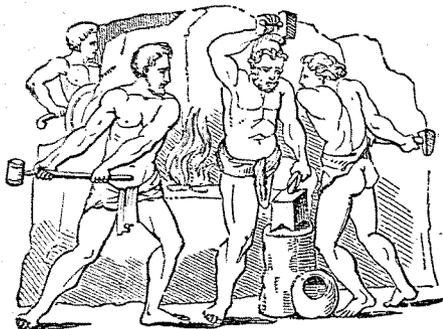
marbre d'une tombe à Rome, elle ressemblait en tout point à celles d'aujourd'hui. La figure du centre tient le fer sur l'enclume (*incus*) avec des tenailles (*forceps*); au pied de l'enclume est un vase plein d'eau pour y plonger le fer et les instruments échauffés. On voit le feu sur l'arrière-plan; et le soufflet (*follis*), avec l'homme qui le manœuvre, est derrière la figure à main gauche.
