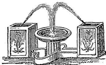
présente une fontaine jaillissante dans le moulin à foulon de Pompéi; ou voit encore les tuyaux sortant des deux réservoirs carrés; on a ajouté l'eau dans le dessin, pour faire comprendre le système des deux jets, et montrer comment ils tombaient, ne formant plus qu'une seule colonne liquide, dans le *labrum* ou bassin central.
