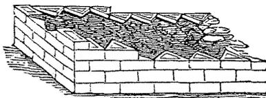
lesquels on remplissait l'intérieur d'une muraille entre les surfaces extérieures, quand le mur n'était pas entièrement construit en maçonnerie ou en briquetage (Vitruv. II, 8, 7), comme le montre le spécimen ci-joint, pris d'une construction romaine.
