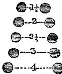
désigner un entre-colonnement de deux diamètres seulement, celui que représente la seconde ligne du diagramme ci-joint, où l'on peut mesurer d'un seul coup d'œil les distances respectives des colonnes dans les cinq différents systèmes d'entre-colonnement qui étaient en usage dans l'antiquité (Vitruv. III, 2).
