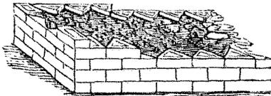
posée de matériaux différents de ceux qui en formaient le corps et l'intérieur, c'est-à-dire de briques ou de moellons régulièrement posés les uns sur les autres, en avant d'une masse irrégulière de pierres de toutes les grosseurs, empâtées de ciment. C'est ce qu'on voit dans le spécimen ci-joint d'une construction romaine (Vitruv. II, 8, 4).
