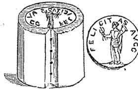
joint, représentant un moule original pour monnaies, avec un spécimen de la pièce, à côté, sur une échelle un peu plus grande. Plusieurs modèles, avec le dessin gravé à l'envers des deux côtés, sont disposés dans la case à une distance l'un de l'autre qui correspond exactement à l'épaisseur qu'on veut donner à la monnaie; on versait le métal liquide dans la cavité latérale d'où il coulait par les trous qu'on voit ici, et produisait une monnaie parfaite entre chaque lit de types.
