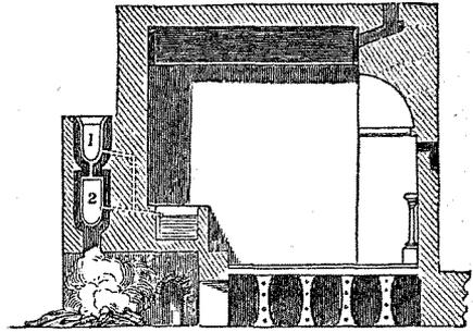
*ad M. Cæs.* I, ep. 2); on les voit clairement dans la gravure ci-jointe, représentant le plan en coupe d'une pièce de bains trouvée dans des fouilles à Tusculum: le fourneau est à gauche avec les chaudières au-dessus, et vers la droite sont les tuyaux qui s'étendent sous tout le plancher de la chambre.
