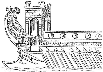
d'un bas-relief en marbre, que le second rang de rames était placé au-dessous du premier, et que l'on comptait les bancs à partir des rebords du pont jusqu'à la ligne de flottaison; les trous qui laissaient passer les rames, et par suite les sièges des rameurs étaient placés en ligne oblique les uns au-dessous des autres, de manière que l'intervalle entre un rang de rameurs et le suivant fût
