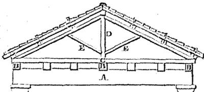
charpente d'un toit (EE dans la figure ci-jointe), pour former un triangle qui rend toute la construction plus forte et plus solide. Dans ce sens, ce mot est le plus souvent employé au pluriel, parce que ces contre-fiches sont en général fixées par couples, se rencontrant au bas et divergeant vers le haut, comme les cornes du
