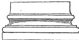
*plate-bande*) placé sous la base (*spira*) d'une colonne (Vitruv. III, 4, 5), et chacun des *filets* ou *listels* à surface unie qui séparent la *scotia* concave des deux *torus* convexes et bombés qui sont l'un au-dessus, l'autre au-dessous de la *scotia* (Id. III, 5, 2 et 3) : tous ces membres se retrouvent dans la figure ci-jointe.
