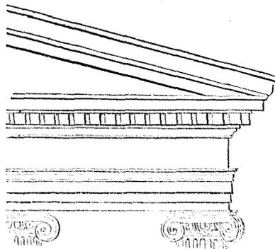
Bacchus, à Téos; car ils sont destinés à représenter extérieurement les têtes des chevrons (*asseres*) dans la charpente d'un toit. Dans quelques édifices des Romains et dans plusieurs des modernes, ils sont placés *sous* les modillons (*mutuli*); mais cela était contraire à l'habitude des Grecs: car leur sens et leur destination
