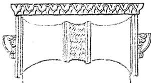
tectes, aux chapiteaux des colonnes ioniques, dont les côtés, formés par la partie latérale des volutes, présentent la figure d'une sorte de cylindre qui ressemble fort à un traversin, comme on le voit dans le spécimen ci-joint, emprunté à un chapiteau du temple de Minerve Polias (Vitruv. I, 2, 65; Id. III, 5, 5),
