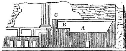
tion de l'*alveus* dans les bains publics de Pompéi. La partie ombrée est le parquet de la chambre, fait de briques, où l'on voit les tuyaux par lesquels l'air chaud circulait, l'un sous le bain lui-même et quatre autres sous le parquet. A est l'*alveus*; B le siège sur lequel s'asseyait le baigneur (*gradus*, Vitruv. *l. c.*);
