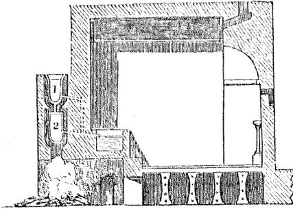
*igneum*), sur laquelle sont placés les vases (*vasaria*, Vitruv. *l. c.*) contenant l'eau chaude et l'eau tiède qu'elle servait à échauffer; et à droite, sous le plancher de la chambre qui est supporté sur plusieurs tubes bas et creux, est un tuyau d'embranchement partant de l'*hypocaustis* et servant à échauffer la chambre qui était au-dessus.
