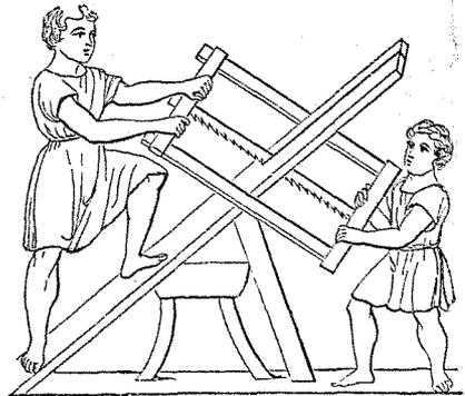
XXXIV, 19, 3). La gravure ci-jointe est tirée d'un vase en terre cuite, de fabrication étrusque ou italienne primitive; elle nous montre l'emploi de ce que nous appelons une *scie allemande*, et une méthode très-simple de soutenir le morceau de bois que l'on va scier, rien qu'avec un support et un étau, sans avoir besoin d'une fosse de scieur de long.
