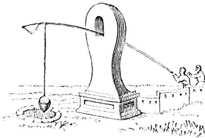
l'eau d'un puits et est encore en usage dans plusieurs parties de l'Europe; elle se compose d'une longue perche, avec une corde et un seau à l'un des bouts et à l'autre un contre-poids, posée en
