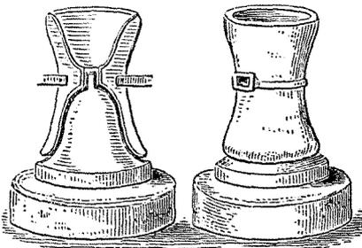
maux le tournaient, et, à mesure qu'il tournait, les épis tombaient graduellement par un trou pratiqué au fond sur la meule inférieure en forme de cône ou cloche (voy. la section), et, pressés entre elle et la surface intérieure du chapeau qui la recouvrait, ils étaient réduits en farine.
