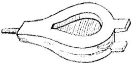
tés du soufflet ; mais elle se referme dès qu'on les presse l'un contre l'autre, et force ainsi l'air comprimé à sortir par le tuyau qui termine l'instrument (Auson. *Mosell.* 269).
