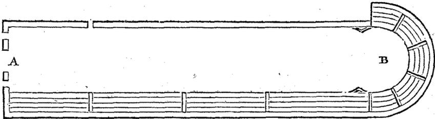
gue terrasse plate dont le côté extérieur est bordé d'un remblai soutenu par des murs, et assez épais pour porter, échelonnées l'une au-dessus de l'autre, plusieurs rangées de sièges ; le côté opposé et le demi-cercle du fond sont creusés dans la colline même, qui est taillée en vingt et un rangs de sièges, disposés en amphithéâtre, et coupés par des escaliers, comme la *cavea* d'un théâtre.
