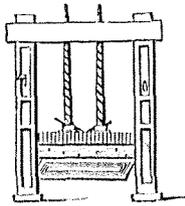
au centre de l'appareil; on a ainsi une machine également puissante, mais plus petite et occupant beaucoup moins de place (Plin. *l. c.*). En réalité, la figure représente une presse à étoffes (*pressorium*); mais, comme cet appareil est construit sur le même principe que celui dont nous nous occupons, il peut bien servir ici de spécimen.
