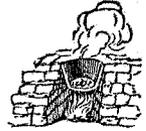
2. *Fornacula balnearum*. Fourneau et tuyaux employés pour échauffer la chambre thermale dans des bains (Front.
