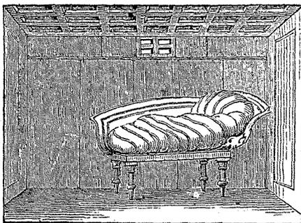
a donné lieu à ce mot (Vitruv. VII, 2, 2; Cic. *Tusc.* v, 21; Hor. *Od.* II, 18, 2). La gravure représente un plafond plat de ce genre d'après le Virgile du Vatican; mais, comme il était d'usage d'imiter la charpente dans le briquetage et la maçonnerie, des cavités de ce genre sont souvent formées dans des plafonds en cintre ou en dôme; le Panthéon de Rome en est un exemple.
