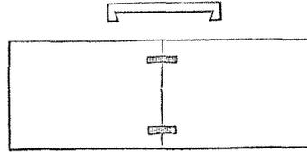
La figure supérieure dans la gravure montre la forme d'un *ancon* de bronze du Colisée, et l'inférieure la manière dont on l'appliquait pour rattacher deux blocs de pierre dans le même édifice.
